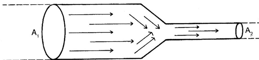
Ducto que reduce su sección transversal de ( $A_1$ ) hasta ( $A_2$ ).
