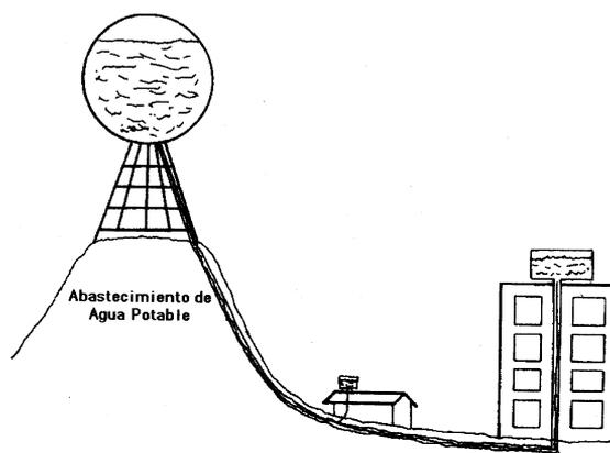
Cuando los recipientes que contienen un líquido se comunican entre sí, presentan una superficie plana, horizontal y colocados a la misma altura, sin importar su forma y capacidad, esto se aprovecha en la instalación de tinacos para el almacenamiento de agua o bien en depósitos de gasolina o petróleo.
