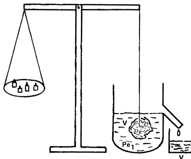
En la actualidad el valor del empuje puede ser medido por medio de la balanza hidrostática, la cual consta de dos platillos en equilibrio, uno de ellos es más corto que el otro. El platillo corto tiene un pequeño gancho donde se pueden colgar diferentes objetos. Para usarla se necesita un marco de pesas y dos vasos de diferentes tamaños, el vaso mayor deberá tener un pequeño pico por donde se pueda verter el agua al derramarse;
