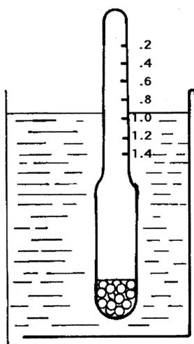
Quizá se haya observado cómo se mide el ácido de un acumulador para saber si la acidez de cada celda es la correcta para su funcionamiento. Al introducir el densímetro el nivel de la escala indica la densidad y con ello la concentración del ácido en el líquido, lo cual sirve al técnico para determinar el funcionamiento del acumulador.
