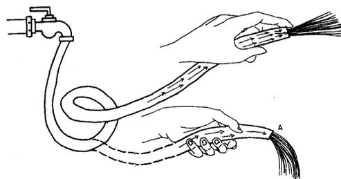
La velocidad del líquido varía según la magnitud de la sección transversal del ducto.
