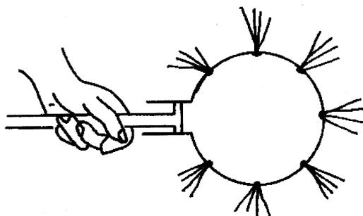
Cuando este principio se aplica a dos columnas de líquido comunicadas entre sí, da lugar a la llamada prensa hidráulica, la cual aprovecha para su funcionamiento que los líquidos transmitan la presión en todos sentidos y direcciones.
